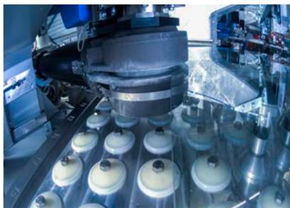
**Innovator bei der Bearbeitung von Fahrzeugglas** – Als erstes Unternehmen konnten wir Diamantwerkzeuge zum Schleifen von Fahrzeugglas mit Geschwindigkeiten bis zu 40 m/min herstellen und erfolgreich das Kantenschleifen am Markt revolutionieren.
