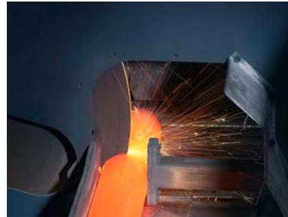
**Marktführer beim Trennen in der Stahlindustrie** – Wir sind der führende Hersteller der weltweit größten Trennscheiben mit Durchmessern von bis zu 2 Metern zum Heißtrennen von Halbzeugen in der Stahlindustrie.
