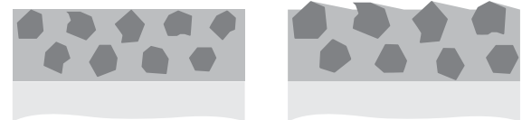
Abbildung 5: Ziel des Schärfens: Erzeugen von Kornüberständen (Mikrogeometrie)
